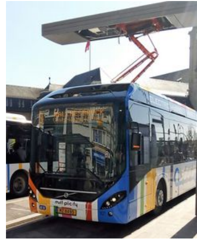
Hybridbus an einer Ladestation Foto: Stauffen
